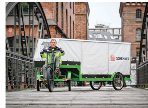
Das Standardmodell und die Basis für das XXL-Rad ist das Cargo-Cycle-Modell Nanuk. Lieferbar in verschiedenen Varianten mit und ohne Nabenmotor und mit einer Nutzlast von 200 kg.
